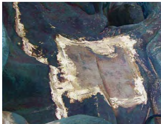
Abb. 22: Neugegossene, eingepasste Bronze- Flickstelle (aus BBL 2003)
