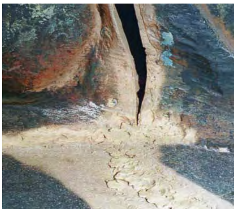
Abb. 21: Riss und Verschweissung (aus BBL 2003)
